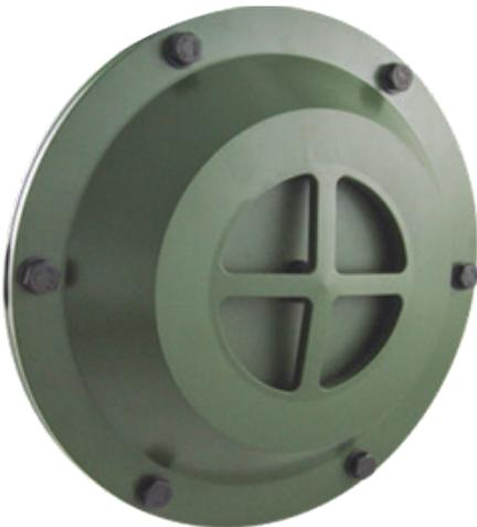
Blast valfler NATO AEP54 standartlarında üretilen Pozitif Basıncı KBRN Sistemlerinde tahliye valfi olarak üretilmektedir. Uygun şartlarda oluşan KBRN sistemi fazla basıncı tahliye eden blast valfler ayarlanabilir yapıdadır. İstenilen basınçlarda ayarlanabilir yaylı yapıya sahip olan blast valfler, kullanıcı isteğine göre özel ölçülerde de üretilmektedir.
