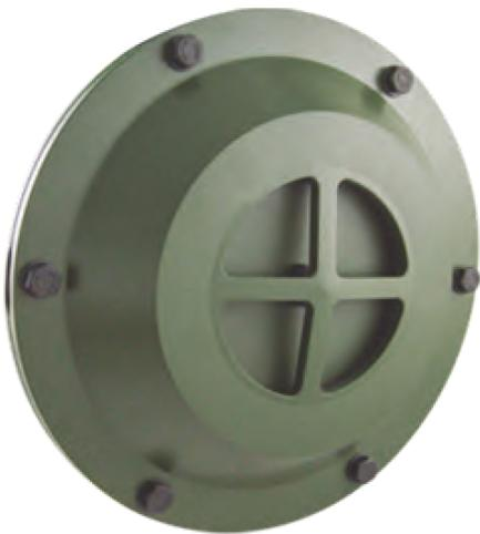
Blast valfler NATO AEP54 standartlarında üretilen Pozitif Basınçlı KBRN Sistemlerinde tahliye valfı olarak üretilmektedir. Uygun şartlarda oluşan KBRN sistemi fazla basıncı tahliye eden blast valfler ayarlanabilir yapıdadır. İstenilen basınçlarda ayarlanabilir yaylı yapılı sahip olan blast valfler, kullanıcı isteğine göre özel ölçülerde de üretilebilmektedir.
